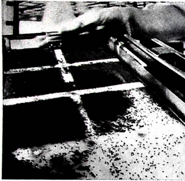
Durch mechanische Erschütterungen werden die Ferritringe in eine vorbereitete Maske gerüttelt
