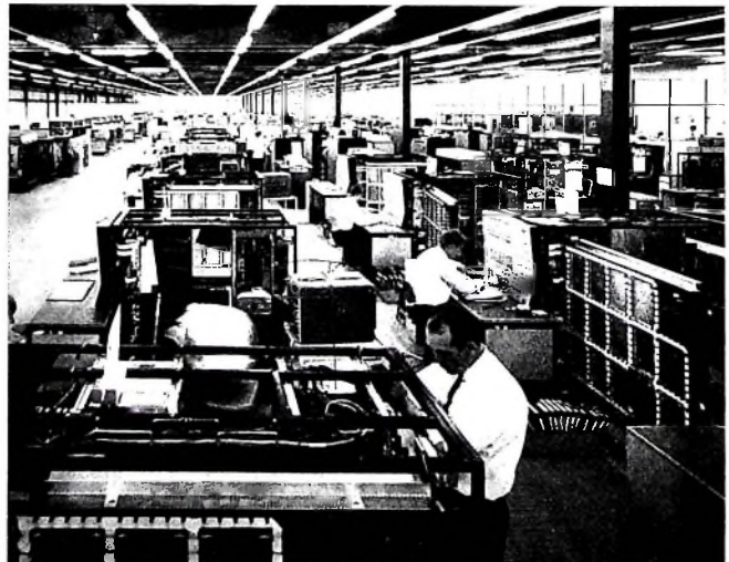
Visuelle Prüfung der Spalten und Zeilen einer Speichermatrix
